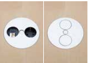
TKB10R Ø 115 mm Ett eluttag. Två USB laddare. Lock borstat rostfritt stål. Två meter kabel. Placering ovanför träbalk. Gäller för SE, NO, DK, FIN, DE, NL. One electrical. Two USB charging. Brushed stainless lid. Two meters cables. Placed above wooden beam. For SE, NO, DK, FIN, DE, NL.
