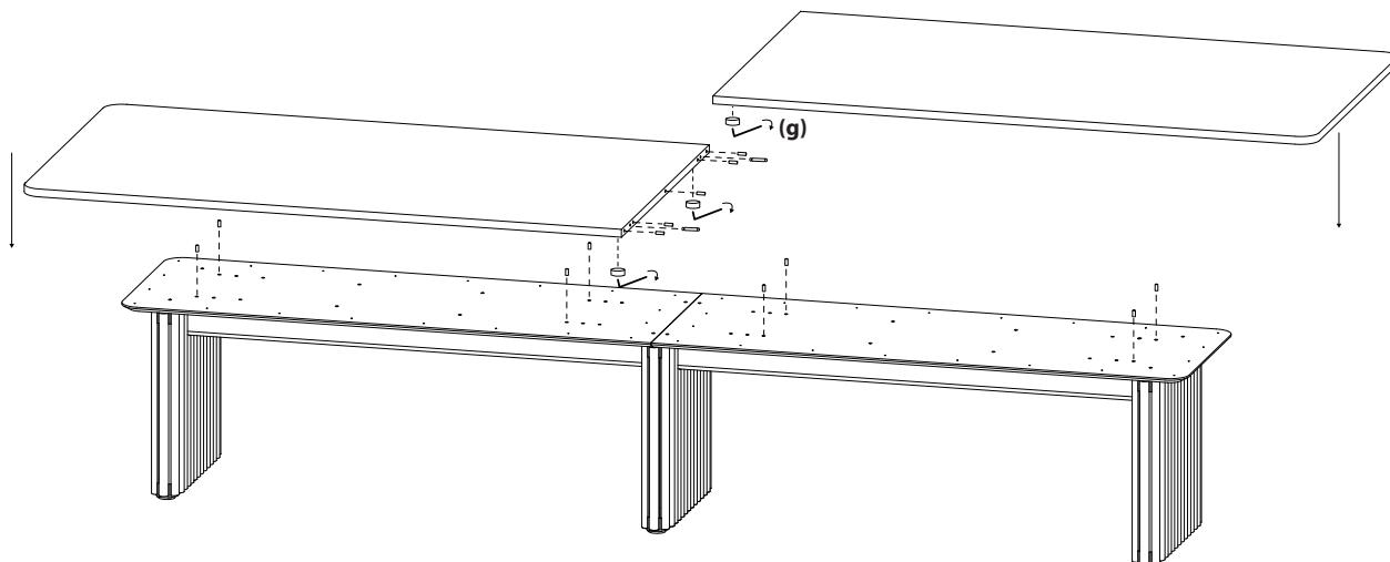
**4. Sätt i styrtapparna i underskivan och mellan topskivorna. Lägg först på ena skivan och därefter skjut in den andra och dra ihop dem med beslaget (g).**
