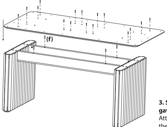
**3. Sätt i styrtapparna (f) i sargen. Lägg på underskivan och skruva fast den ner i gavlar och sarger**
