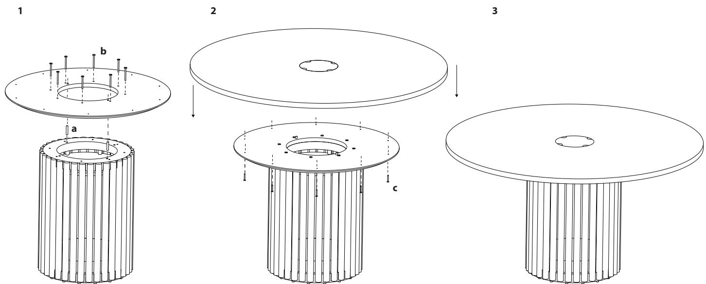
**1. Sätt i styrtapparna (a), lägg på underskivan och skruva fast den i pelaren med bultarna (b).**
