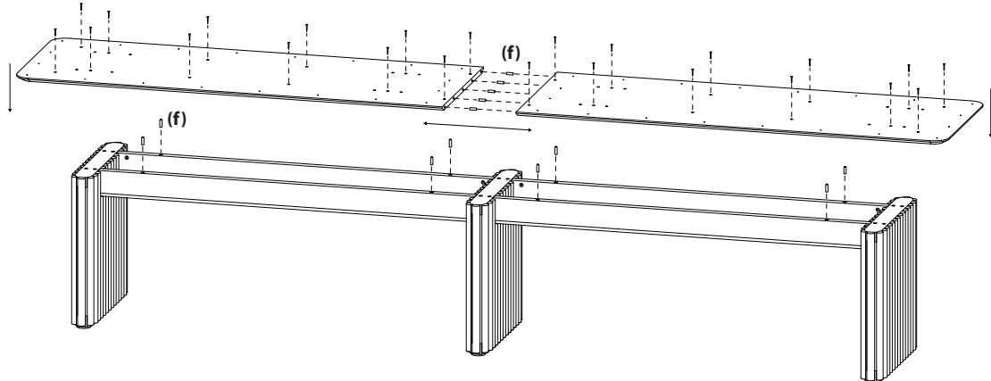
**3. Sätt i styrtapparna (f) i sargen och mellan underskivorna. Lägg på underskivorna och skruva fast dem ner i gavlarna och sargerna**
