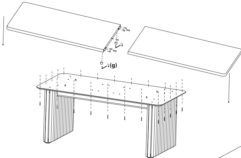
**4. Sätt i styrtapparna i underskivan och mellan topskivorna. Lägg först på ena skivan och därefter skjut in den andra och dra ihop dem med beslaget (g).**
