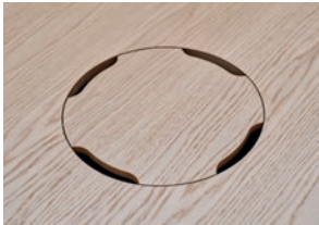
TKB16C Ø 270 , D 105 Kabelgenomföring med elbrunn. Lösa lock. Exkl. eluttag. Placeras i skiva ovanför pelare. Endast pelare Ø 490 mm. Cable slot with box. For socket and leads. Loose covers. Excl. electrical equipment. Placed on top above pedestal. Only for pedestal Ø 490 mm.
